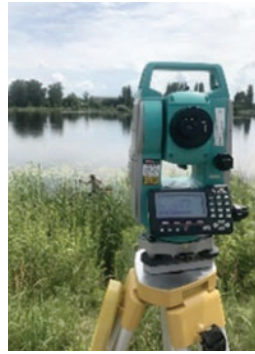
Електронний тахеометр — Sokkia Set 530RK
