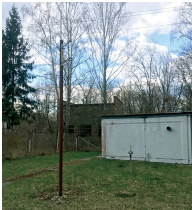
Рис. 1. Типовий пост спостереження за гамма-фоном у 30-км зоні ЧАЕС. Детектор GammaTRACER на мачті на висоті ~4 м
